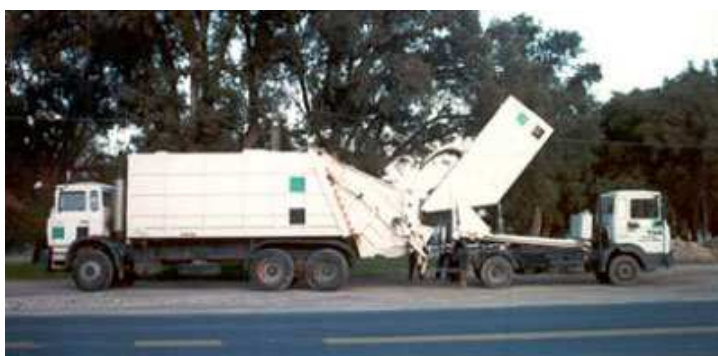
Ilustración 3. Transferencia de residuos domésticos de camión de recogida (satélite) a camión recolector-compactador de gran capacidad (nodriza), para su transporte a la planta de tratamiento de residuos.
